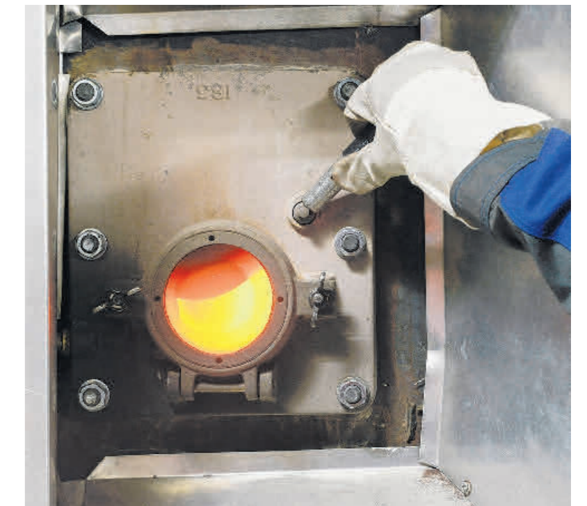
Schauglas im Verbrennungsofen, der den gesamten Klärschlamm von Hamburg Wasser sowie verschiedene Fremdschlämme verbrennt. Foto: J. Böthling
