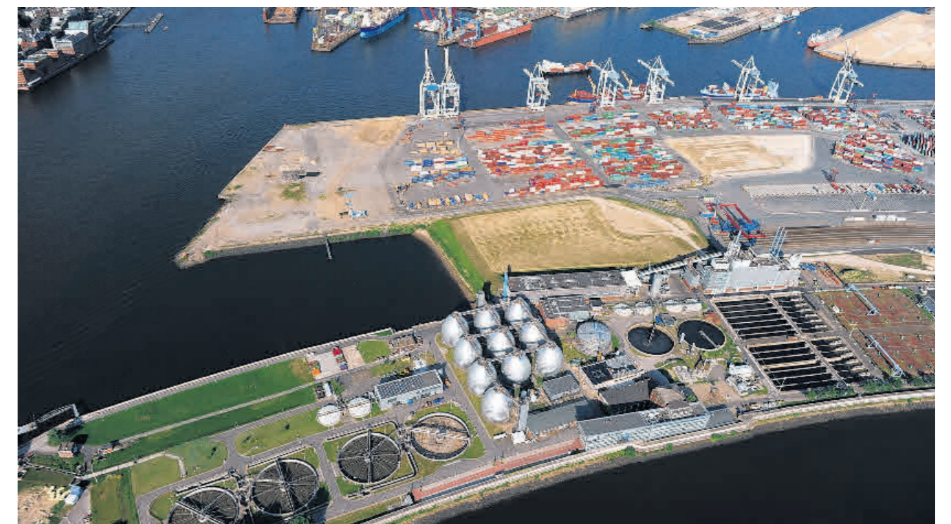
Das Klärwerk Köhlbrandhöft von Hamburg Wasser mit seinen markanten Faultanks, den Klärbecken und der Klärschlammverbrennungsanlage VERA an der Süderelbe im Hamburger Hafen. Foto: Jörg Böthling
