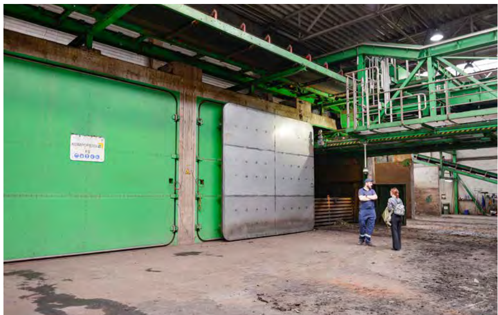
Garagenfermenter auf der Biogas- und Kompostierungsanlage am Stadtrand von Poznan.
