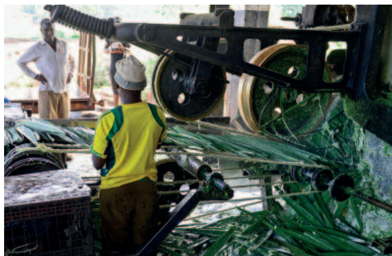
Diese Maschine löst die Fasern aus den Blättern.
